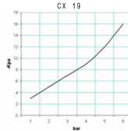
Consumo de aire (NI/s) según la presión de alimentación (bar)
