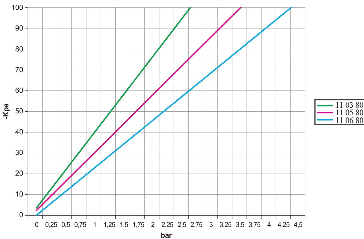
Nota: Los valores detectables con las tablas son meramente indicativos, ya que dependen de la presión atmosférica, del caudal de la fuente de vacío y de la calidad del aire comprimido de alimentación
