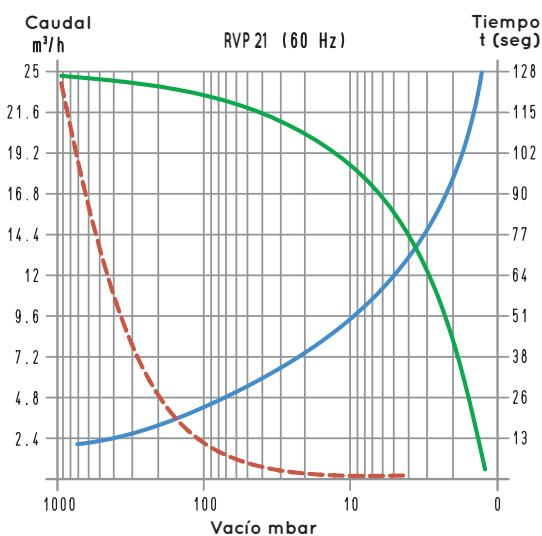
Para calcular el tiempo de vaciado de un volumen  $V_1$ , aplique la siguiente fórmula:  $t_1 = \frac{t \times V_1}{V_0}$
